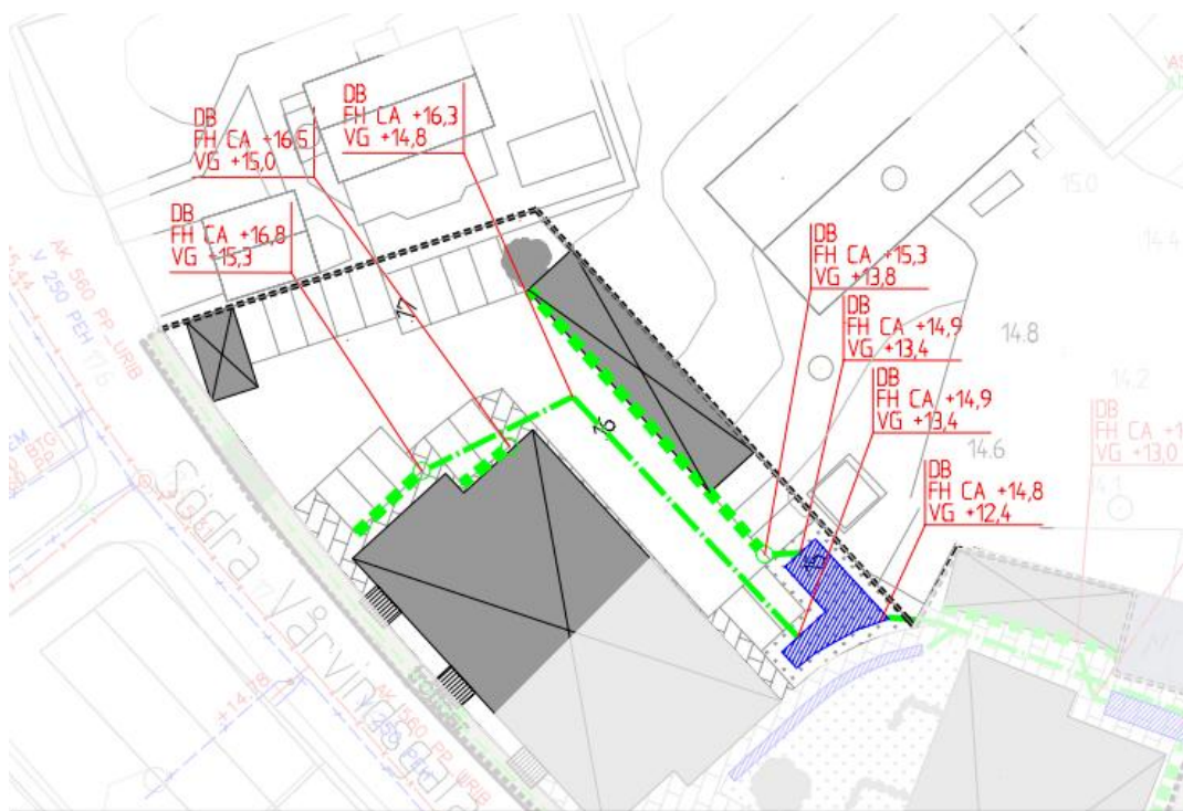
Figur 6. Avrinningsområde 1 föreslås i första hand avvattnas med hjälp av rännor (grönstreckade); fördröjning föreslås ske i en underjordisk stenkista (blåskrafferad).
